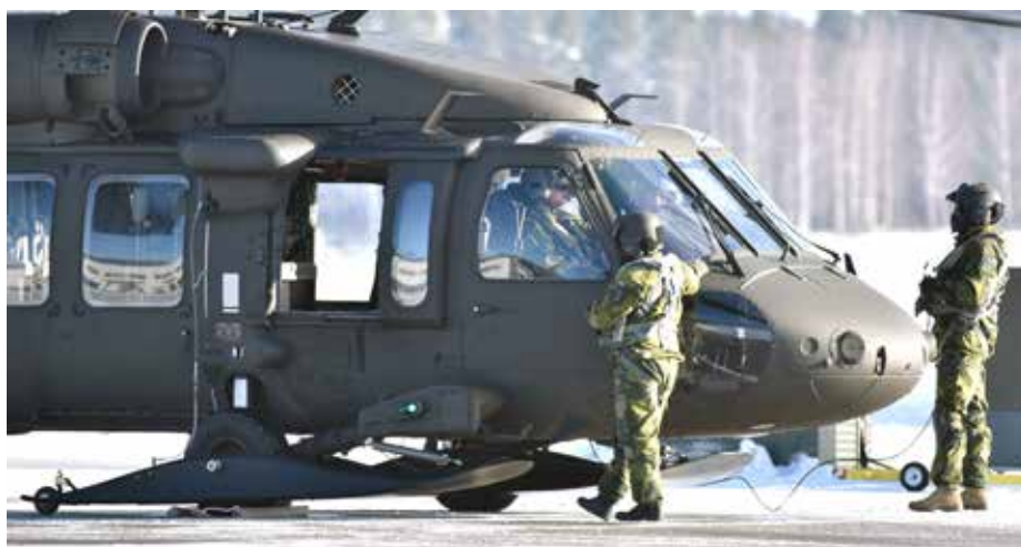
Hjulen sticker ner under skidorna så att det går fortfarande att rulla på marken. Foto Christian Graversen/Försvarsmakten.
