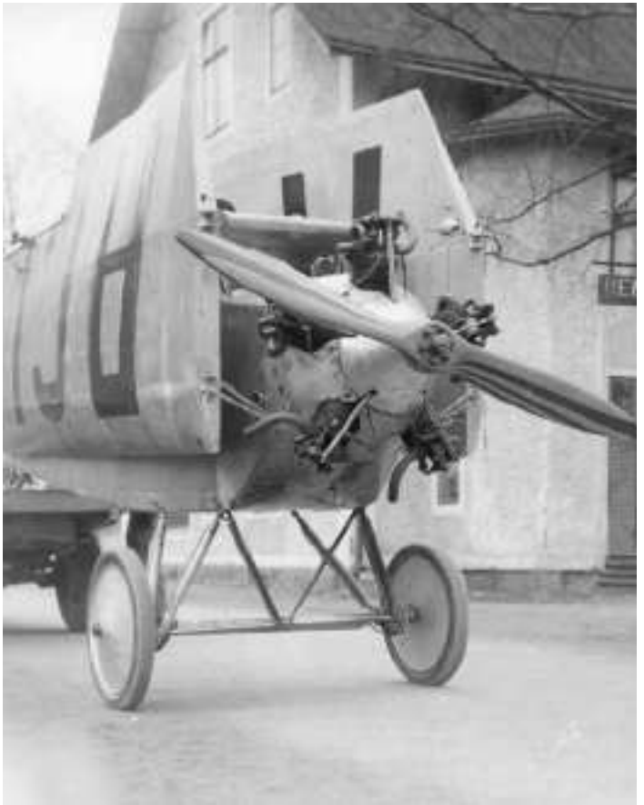
En av de få bilder med SE-ACL på hjul under en marktransport. Praktiskt att låta flygplanet rulla på egna hjul och enkelt att hänga upp de demonterade vingarna på kroppssidorna. Foto SFF:s bildarkiv.
