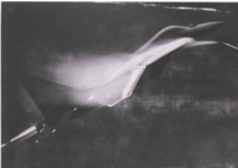
Blåsning av en MiG 29-modell i KTH:s låghastighetstunnel L2, rökförsök. Foto FMV.
