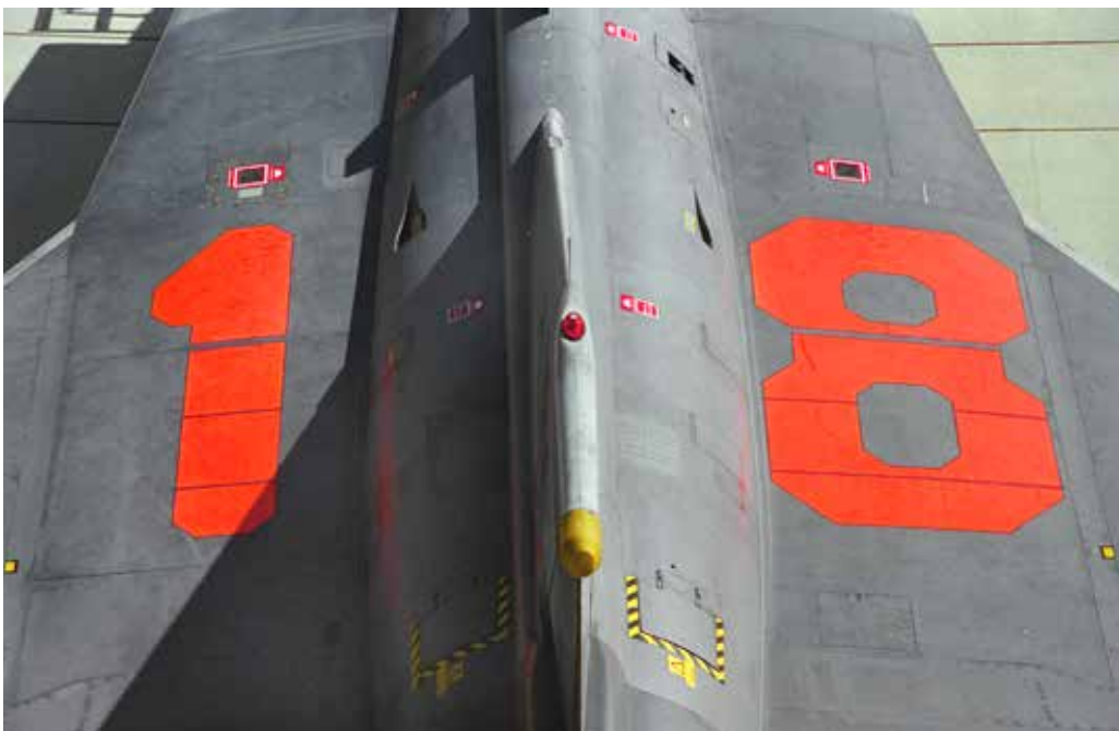
Siffermärkning på J 35 OE för att lättare se och identifiera varandra under luftstridsövning, klart inspirerad av svenska Flygvapnets märkning. Märkningsritningen till höger fastställdes den 12 april 1991, varefter flygplanen målades enligt bilden ovan. Foto Johann Janschitz.
