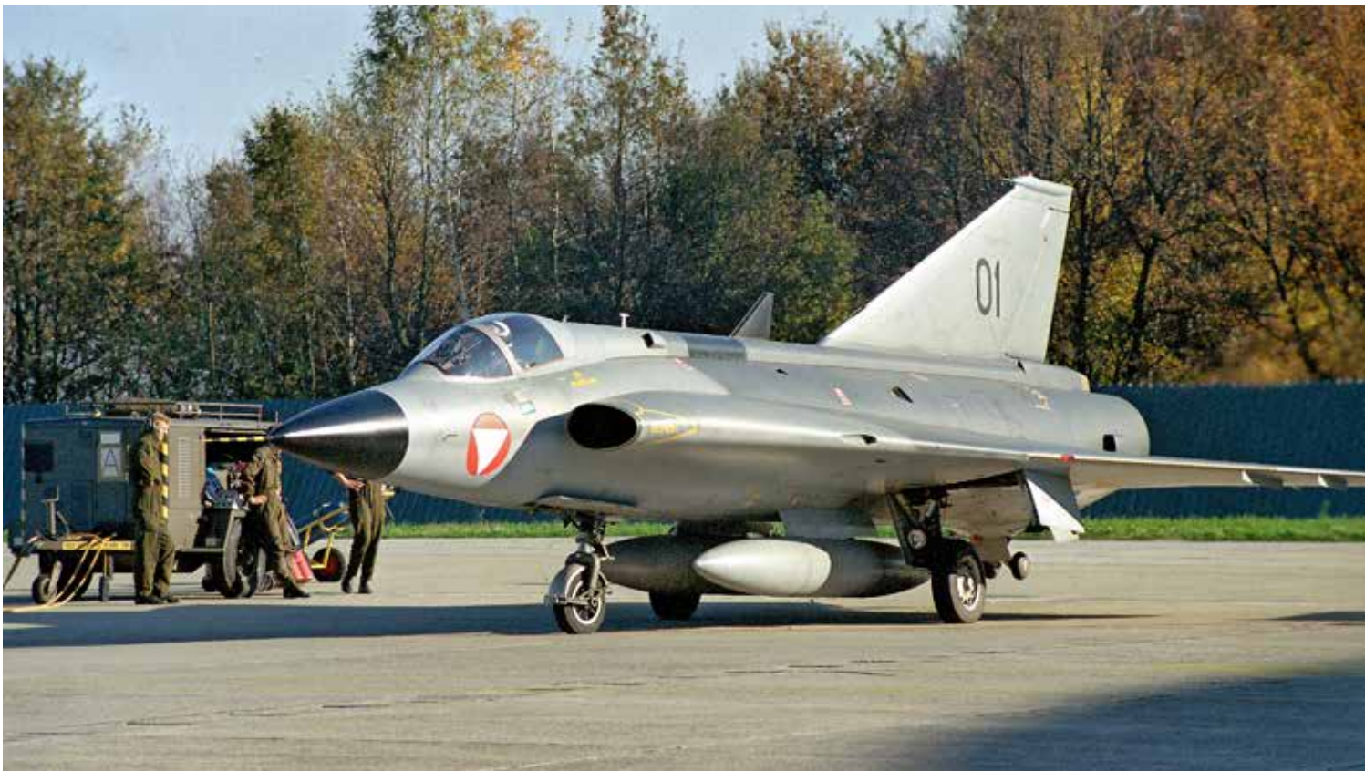
Lägg märke till J 35F-huven på J 35 OE istället för den gängse låga huven på J 35D. F-huven var mer komfortabel genom den ökade huvhöjden. Foto Johann Janschitz.
